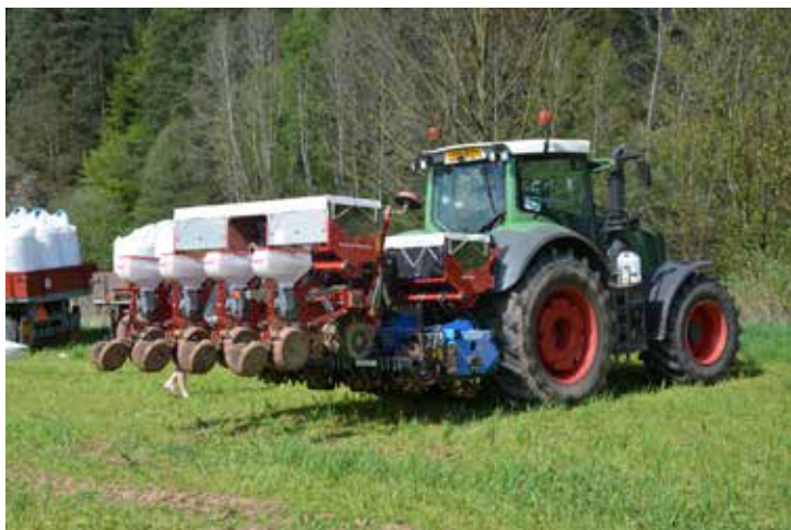
Obr. 62: Zakládání porostů kukuřice seté strojem Rotor Strip Till v kombinaci se secím strojem Mascar Maxi 5 (foto Hovad).
