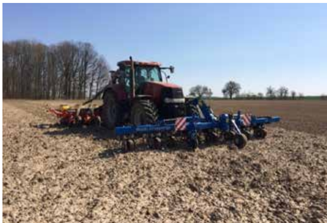
Obr. 143: Souprava pro současné provedení předsetové přípravy a seti kukuřice (foto Kroulík).
