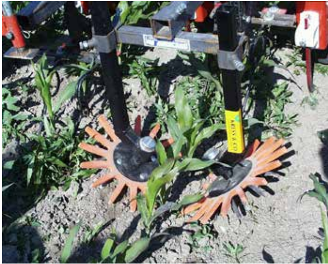
Obr. 133: Při aplikaci herbicidů do meziřádku lze provést odplevelení řádku s kukuřicí setou například osazením plečky pracovními nástroji s prstovými koly (foto Brant).
