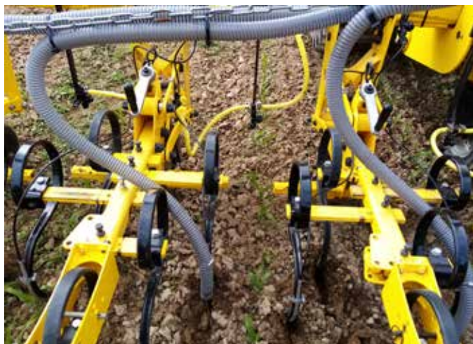
Obr. 132: Pásová aplikace fungicidu na řádek kukuřice se současnou kultivací meziřádku v kombinaci s aplikací pevných minerálních hnojiv za kypřící dlátka (foto Brant).
