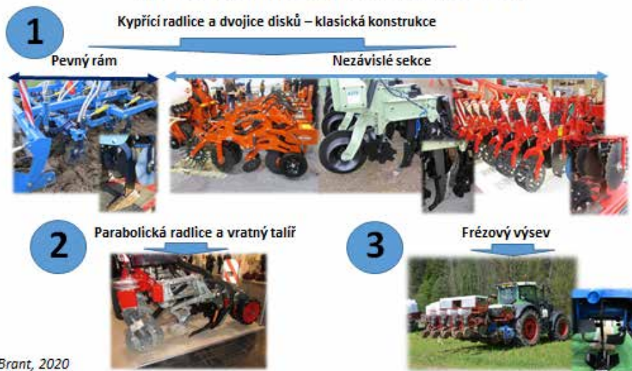
Obr. 53: Pro pásové zpracování půdy ke kukuřici seté lze dnes využít rozdílná technická řešení umožňující pásové zpracování půdy.
