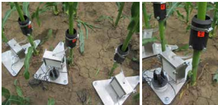
Obr. 30: Kontinuální měření stoku vody po stéble kukuřice seté pomocí automatických stem flow metrů (foto Brant).
