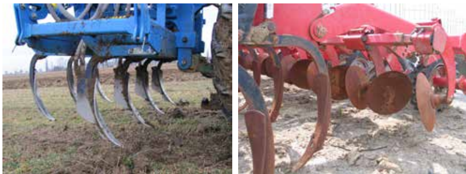
Obr. 71: V Evropě preferovaný systém tvorby hrůbků pomocí systémů kypřících radlic, či radlic a tvarovacích talířů (foto Brant a Kroulík).
