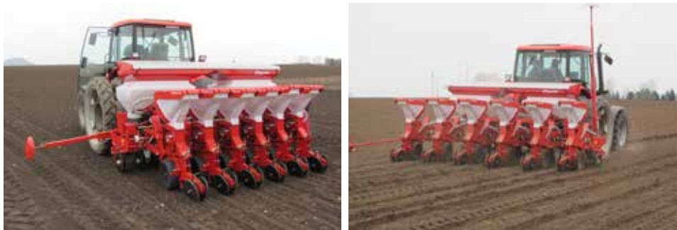
Obr. 95: Pro výsev porostů byl použit šestiřádkový secí stroj Kverneland Accord Optima HD, výsev do řádků 0,45 m vlevo a 0,75 m vpravo (foto Brant).
