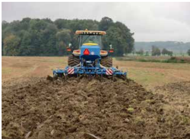
Obr. 72: Stroje pro tvorbu hrůbků lze doplnit o systémy aplikace minerálních hnojiv do středu budoucího hrůbku (foto Farmet a.s. ).
