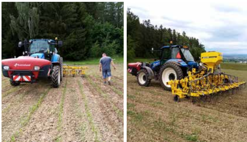
Obr. 134: Souprava pro kultivaci kukuřice během vegetace vybavená zásobníky pro současnou aplikaci kapalných a pevných látek (foto Brant).
