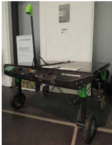
Obr. 70 Robotická platforma, určená pro potlačování plevelných rostlin v širokořádkových plodinách (foto Kroulík).
