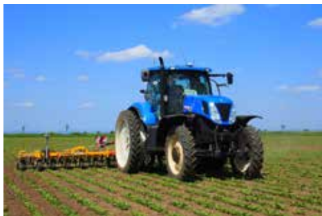
Obr. 69 Optický senzor určený pro přesné vedení kultivátoru v meziřádku (foto Kroulík).
