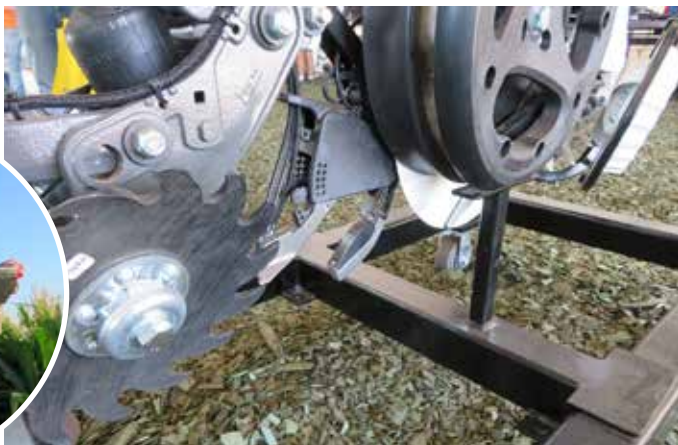
Obr. 35 Detail senzoru SmartFirm a jeho umístění na secí botce (foto Kroulík).
