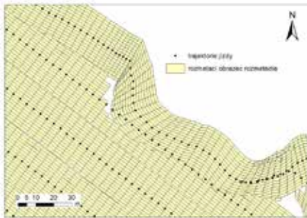
Obr. 61 Detail záznamu práce rozmetadla s ukázkou omezení rozhozu hnojiva.
