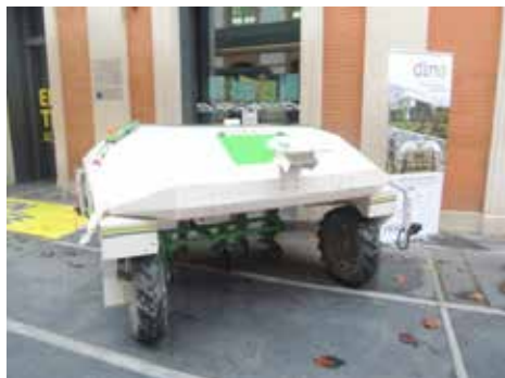
Obr. 71 Univerzální robot s kombinací družicové navigace a kamerového systému (foto Kroulík).
