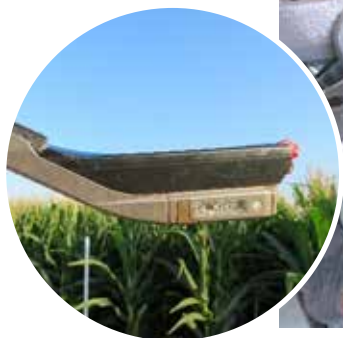
Obr. 35 Detail senzoru SmartFirm a jeho umístění na secí botce (foto Kroulík).
