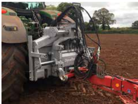
Obr. 47 Systém aktivního navádění stroje do požadovaných jízdních stop při práci na svazích pomocí posuvného závěsu nebo doplněním druhé navigace na stroj a řízením traktoru (firemní materiály Strom Praha a.s.).
