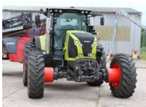
Obr. 50 Rozšíření rozchodu kol s použitím speciálních náprava a koncových převodů. (foto Kroulík)
