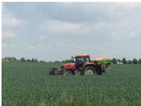
Obr. 2 Traktor Case v agregaci s rozmetadlem Amazone během přihnojování porostu pšenice. Senzory OptRx jsou nesené na předním závěsu (foto: Kroulík).
