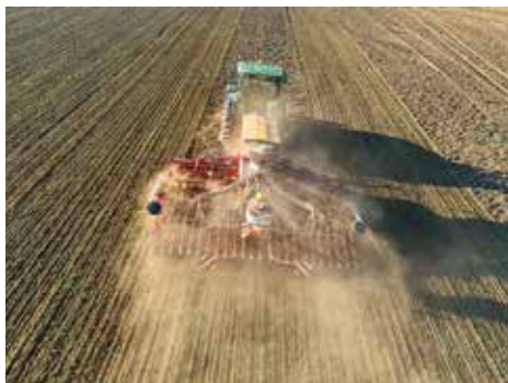
Obr. 47 Systém aktivního navádění stroje do požadovaných jízdních stop při práci na svazích pomocí posuvného závěsu nebo doplněním druhé navigace na stroj a řízením traktoru (firemní materiály Strom Praha a.s.).
