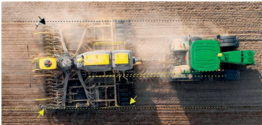
Obr. 17. Secí stroj s dvoukomorovým zásobníkem na osivo a přídatným zásobníkem pro výsev třetí plodiny. Traktor je pomocí automatického řízení veden proti svahu tak, aby s maximální přesností vedl krajovou botku v předchozí jízdě, čímž je dosaženo pravidelného střídání setých plodin a dodržení meziřádkové vzdálenosti (foto Strom Praha).
