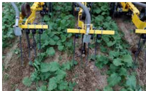
Obr. 80: Kombinace meziřádkové kultivace a pásového postřiku řádků ozimé řepky herbicidem (foto Brant).
