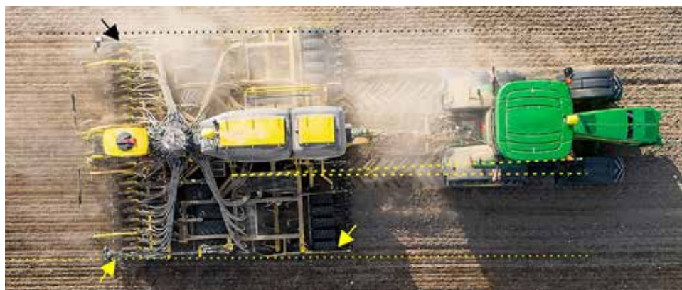
Obr. 19: Secí stroj s dvoukomorovým zásobníkem na osivo a přidavným zásobníkem pro výsev třetí plodiny. Traktor je pomocí automatického řízení veden proti svahu tak, aby s maximální přesností vedl krajevou botku v předchozí jízdě, čímž je dosaženo pravidelného střídání setých plodin a dodržení meziřádkové vzdálenosti (foto STROM Praha).
