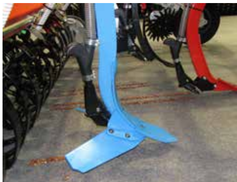
Obr. 25: Pro zakládání druhově pestrých směsí s rozdílnou velikostí semen jsou využívány stroje provádějící řádkový výsev větších semen a menších semen na široko (foto Brant).
