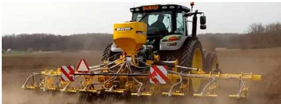
Obr. 10: Založení jarních pásových výsevů pomocných plodin pomocí plečky vybavené zásobníkem osiva a systémem jeho transportu za kypřící sekce. Stejný stroj lze použít i pro pásovou přípravu půdy v budoucích pásích určených pro výsev hlavní plodiny (foto Brant).
