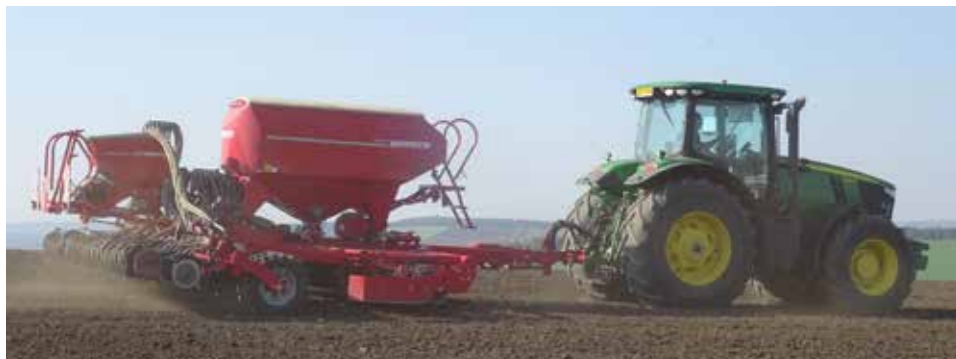
Obr. 14: Jednokomorový secí stroj pro výsev úzkořádkových plodin vybavený přídatným zařízením pro plošný výsev pomocné plodiny (foto Hanáček).
