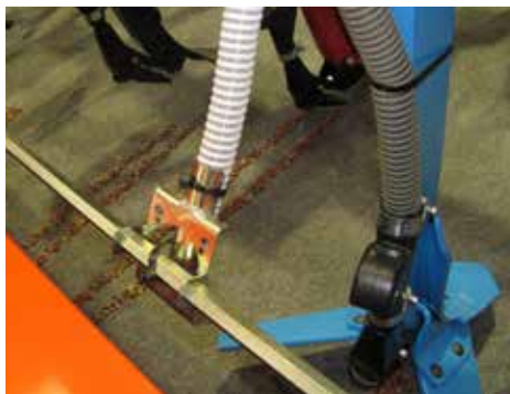
Obr. 25: Pro zakládání druhově pestrých směsí s rozdílnou velikostí semen jsou využívány stroje provádějící řádkový výsev větších semen a menších semen na široko (foto Brant).
