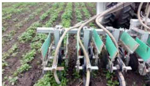
Obr. 74: Porost sóji luštinaté s meziřádkem osetým hořčicí bílou, souběžný výsev, /vlevo/ a proplečkování meziřádků po vzejití porostu /vpravo/ (foto Brant).
