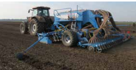
Obr. 18: Secí stroj se dvěma nezávislými zásobníky na osivo umožňující nezávislý výsev dvou plodin pomocí secích botek (foto Brant)
