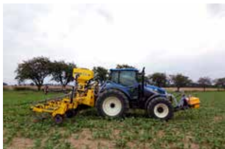
Obr. 80: Kombinace meziřádkové kultivace a pásového postřiku řádků ozimé řepky herbicidem (foto Brant).
