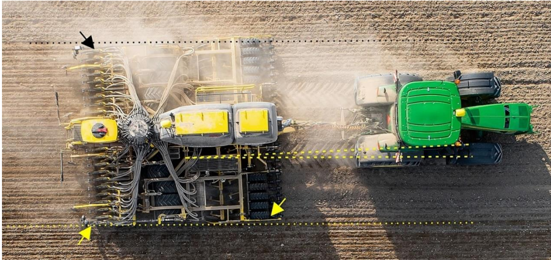
Obr. 5: Traktor je pomocí automatického řízení veden proti svahu tak, aby s maximální přesností vedl krajovou botku v předchozí jízdě, čímž je dosaženo pravidelného střídání setých plodin a dodržení meziřádkové vzdálenosti (foto STROM Praha)
