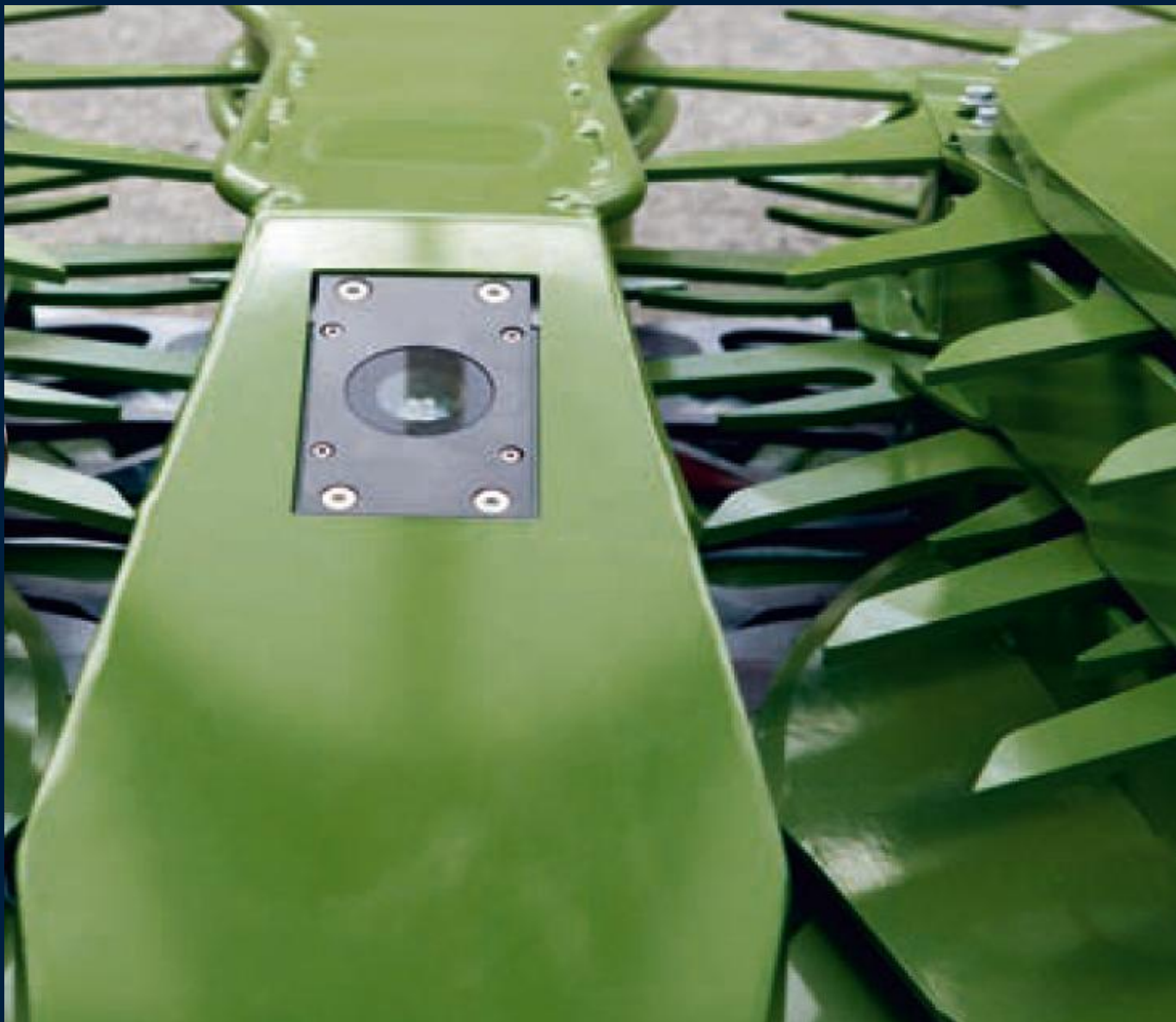
Optické čidlo firmy Krone vyhodnocující zralost sklízeného porostu kukuřice. Firemní literatura, upraveno.
