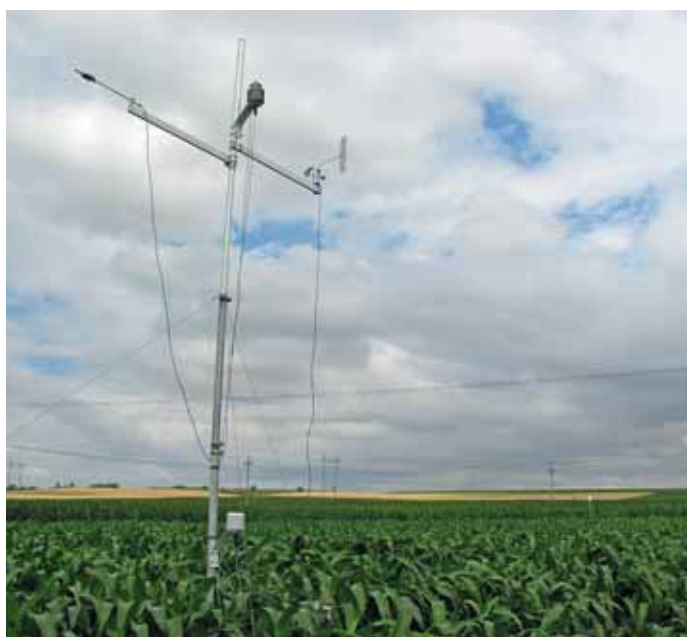
Stanovení hodnot aktuální (měřené) evapotranspirace v porostu čiroku systémem BREB (výrobce EMS Brno, CZ)
