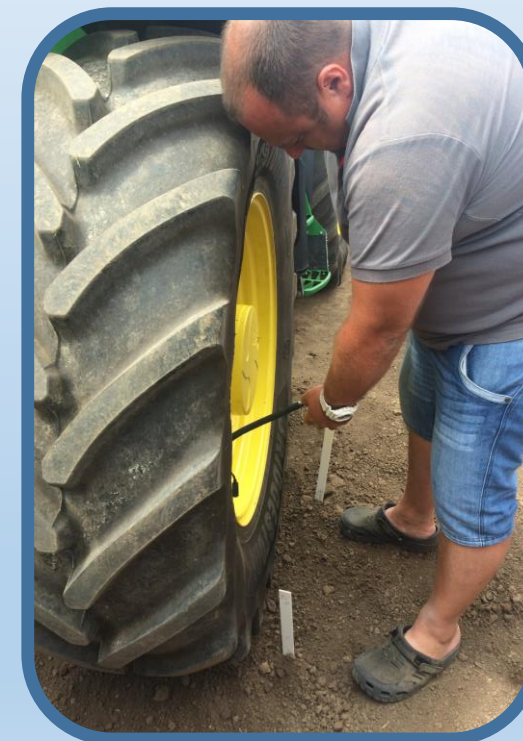
Představení práce se sadou na dohušťování pneumatik na požadovaný tlak.
