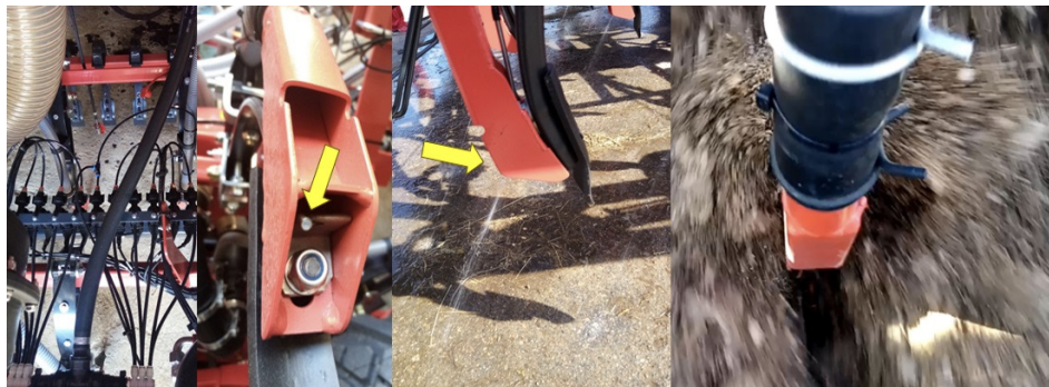
Obrázek 46: Detailní pohled na systém rozvodu kapaliny k výsevním botkám (vlevo), umístění trysky a tok kapaliny (uprostřed) a aplikace kapalných látek za výsevní jednotku do rýhy s osivem před jejím uzavřením zeminou (vpravo), foto Brant .
