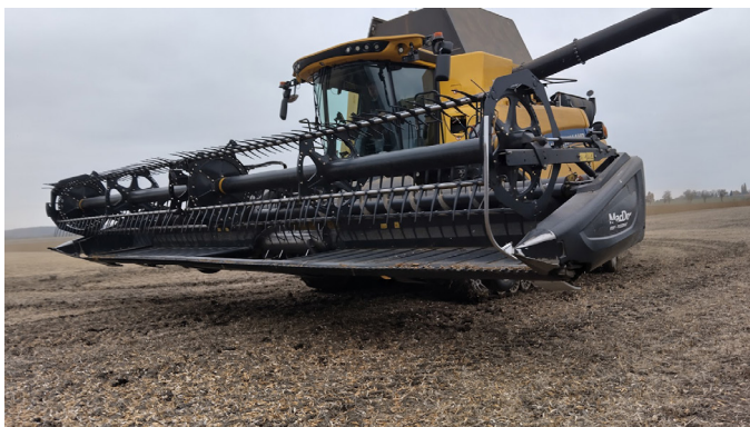
Obrázek 89: Flexibilní adaptér MacDon Flex draper vhodný pro sklizeň hrachu (foto Procházka).
