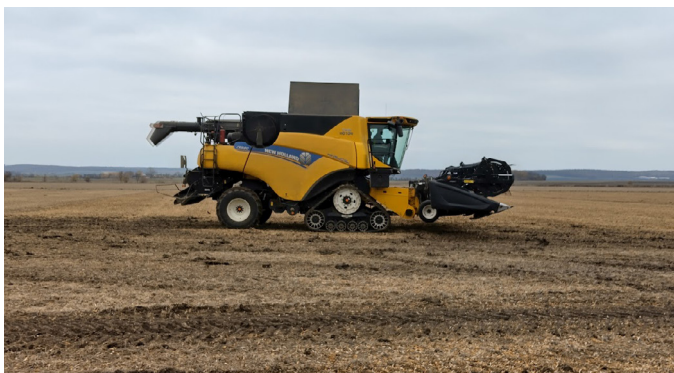
Obrázek 90: Pásový pohon sklízecí mlátičky v kombinaci s flexibilní lištou (foto Procházka).
