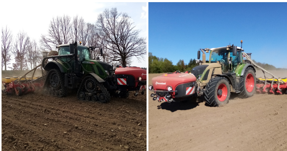
Obrázek 43: Secí souprava přesného secího stroje Väderstad Tempo a čelně nesené nádrže Kverneland iXtra při výsevu s aplikací symbiotických bakterií k řádku osiva (foto Brant).
