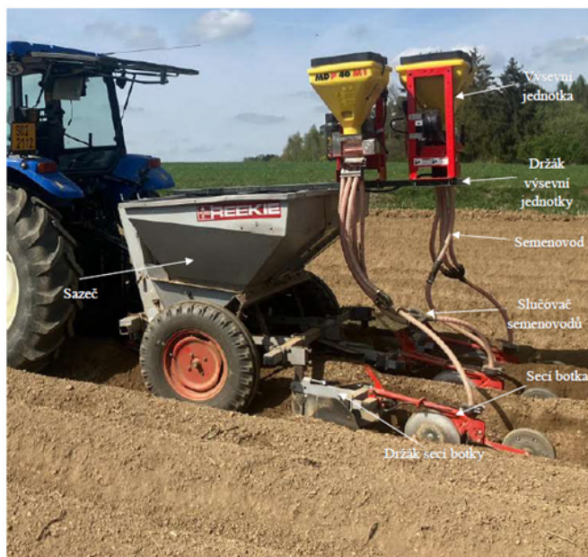
Obrázek 85: Modifikovaný sazeč pro výsev pomocných plodin (zpracoval Holejšovský).
