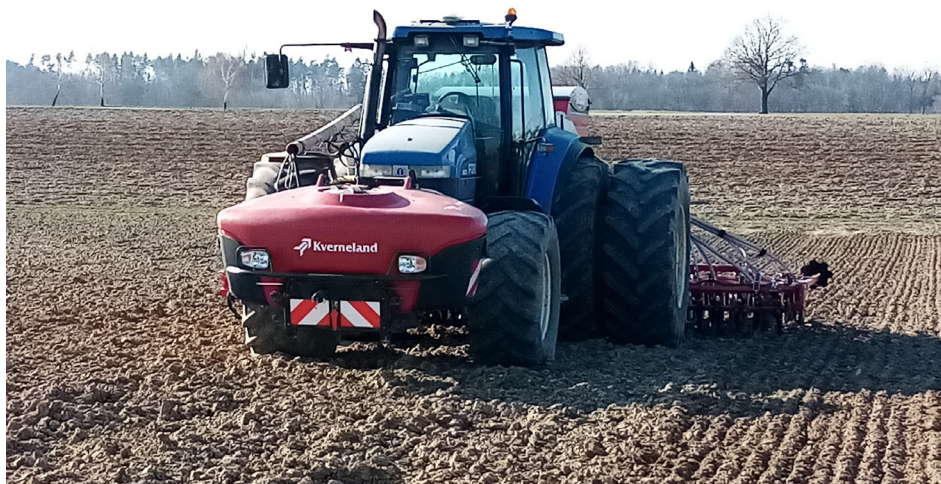
Obrázek 45: Modifikace secího stroje Kverneland ts-drill (záběr 6 m) pro výsev plodin do řádků 0,25 m se souběžnou aplikací bakterií do výsevní rýhy z čelně nesené nádrže Kverneland iXtra ( foto Brant ).
