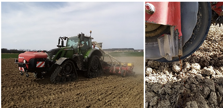
Obrázek 70: Výsev hrachu polního do širokých řádků secím strojem pro přesné setí se souběžnou aplikací kapalných látek k osivu. Jícha byla aplikována z čelně nesené nádrže a vývody aplikátorů byly svedeny k vyústění přihnojovacích disků (foto Brant).
