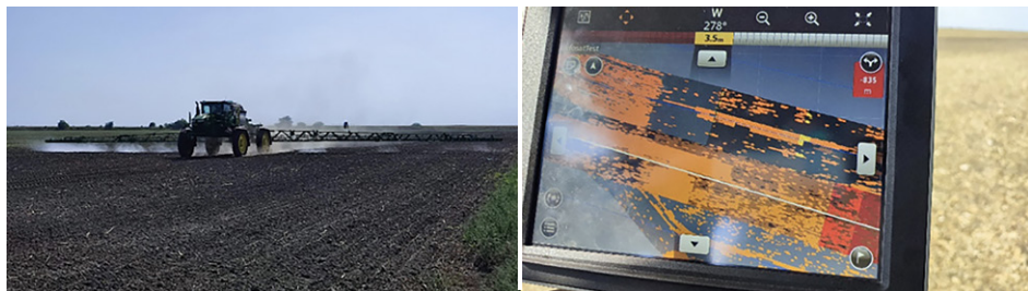
Obr. 108: Cílená aplikace na rostliny plevelů a výdrolu postřikovače John Deere 612R (vlevo) a ukázka mapy (vpravo) dokládající zóny s aplikací herbicidu (foto Brant).
