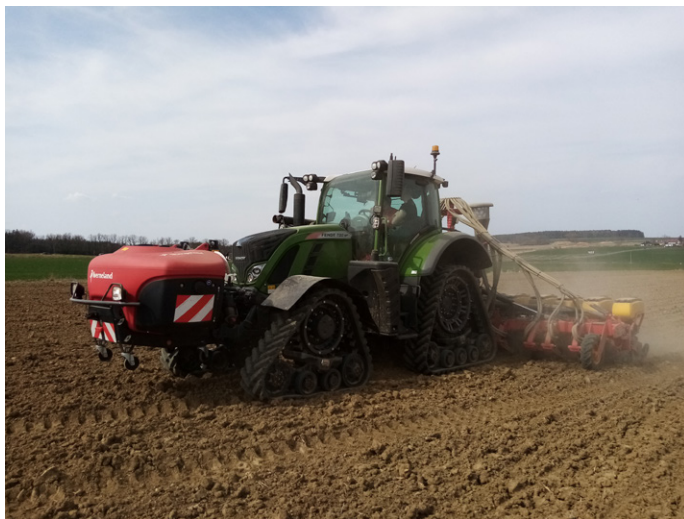
Obr. 20: Secí souprava přesného secího stroje Väderstad Tempo a čelně nesené nádrže Kverneland iXtra při výsevu porostů sóji s aplikací symbiotických bakterií k řádku osiva (foto Brant).
