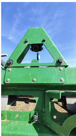
Obr. 109: Detail RGB kamery umístěné na rámu postřikovače pro detekci zelené barvy. RGB kamery jsou u tohoto postřikovače umístěny ve vzdálenosti 1 m od sebe po celé délce ramen (foto Brant).
