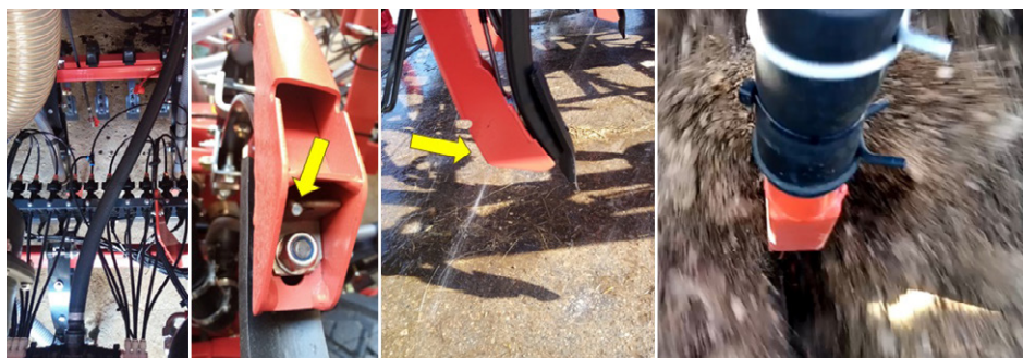
Obr. 23: Detailní pohled na systém rozvodu kapaliny k výsevním botkám (vlevo), umístění trysky a tok kapaliny (uprostřed) a aplikace kapalných látek za výsevni jednotku do rýhy s osivem před jejím uzavřením zeminou (vpravo) (foto Brant).
