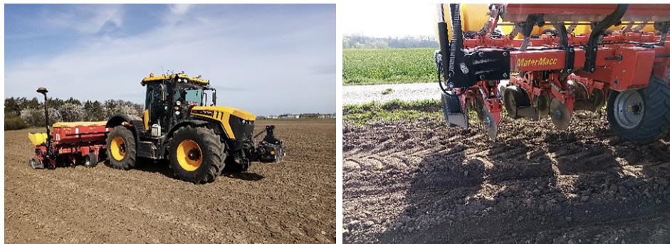
Obr. 56: Limitujícím faktorem rozvoje pěstování sóji systémem dvouřádků je dostupnost secích strojů určených pro tuto technologii (foto Brant)
