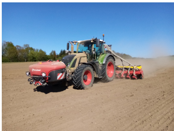
Obr. 24: Souprava secího stroje Väderstad Tempo a čelně nesené nádrže Kverneland iXtra při výsevu porostů sóji (foto Brant).
