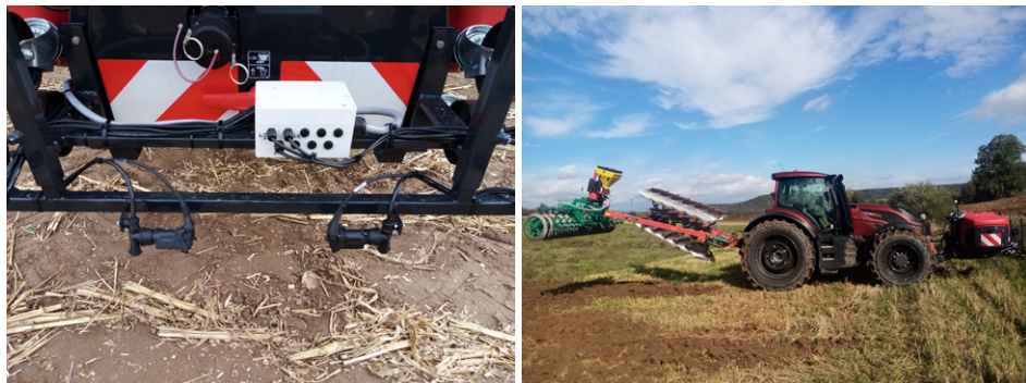
Obr. 29: Aplikace bakterií na povrch půdy před provedením orby se souběžným výsevem meziplodin za půdní péč. Aplikace bakterií z čelní nádrže je prováděna na záběr pluhu (foto Brant).
