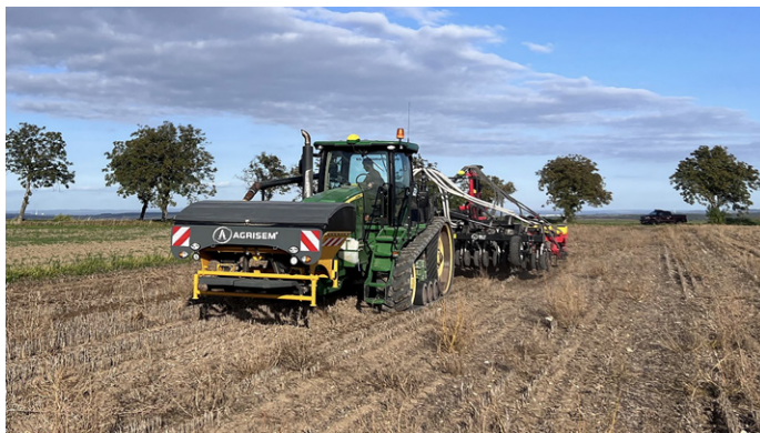
Obr. 50: Pracovní souprava pro souběžné provedení pásového zpracování půdy se zonálním hnojením a přesným výsevem plodiny do kypřených pásů (foto Švarc).
