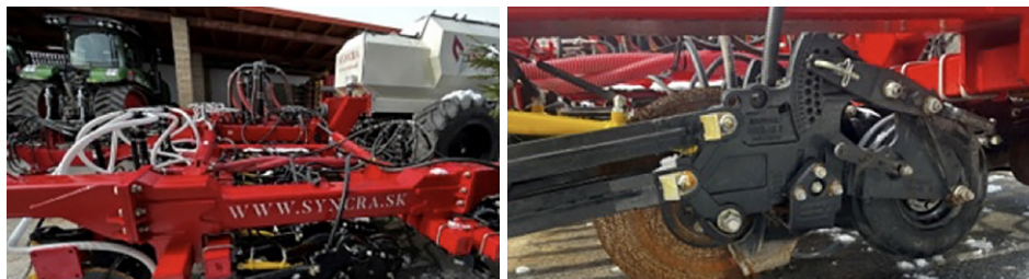
Obr. 77: Secí stroj Bourgault CD872 Frame Mounted Seeder s roztečí řádků 190,5 mm použitý pro založení porostů sóji luštinaté (foto Jenček).
