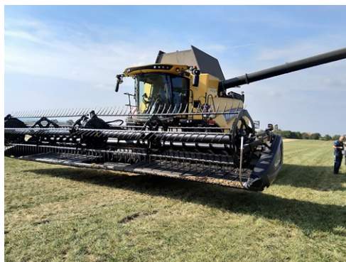
Obr. 111: Flexibilní adaptér MacDon Flex draper vhodný pro sklizeň sóji (foto Procházka P.).
