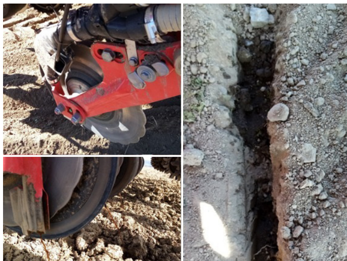
Obr. 21: Vyvedení aplikačních hadiček k přihnojovacím diskům secího stroje (vlevo) a následný rozptyl kapaliny v místě aplikace (vpravo), (foto Brant).
