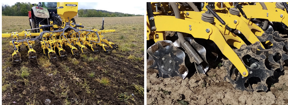
Obr. 51: Systém mělkého pásového zpracování půdy před výsevem sóji do vymrzlé meziplodiny pomocí systému zvlněných talířů, šířka kypřeného pásu je 0,22 m (foto Brant).
