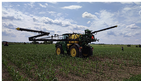
Obr. 68: Pro pásovou aplikaci přípravků na ochranu rostlin v sóje lze využít konvenční postřikovače se základní roztečí trysek 0,25 m a s možností individuálního vypínání jednotlivých trysek. Tyto technické prostředky jsou do stupně jako samohodné, ale i tažené a nesené (foto Brant).
