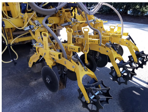
Obr. 53: Stroje pro mělké pásové zpracování půdy lze využít pro přípravu půdy v místě budoucího výsevu plodin, ale i pro meziřádkovou kultivaci, včetně pásové aplikace kapalných látek (na obrázku je systém pro meziřádkovou pásovou aplikaci kapalných látek). Rámy strojů jsou vybaveny v tomto případě možností automatického posunu při jízdě (foto Brant).
