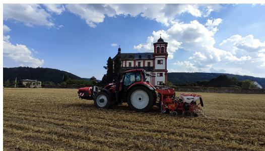
Obr. 70: Při výsevu sóji v systémech s pomocnou plodinou v meziřádku, obdobně jako v dalších technologiích, lze využít secí stroje pro přesné setí osazené systémem pro pásovou aplikaci herbicidů při výsevu (foto Brant).
