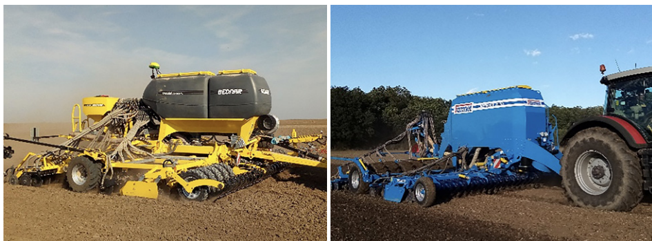
Obr. 41: Diskové secí stroje s pneumatickým transportem osiva jsou standardně využívány pro výsev sóji do úzkých řádků (foto Brant).
