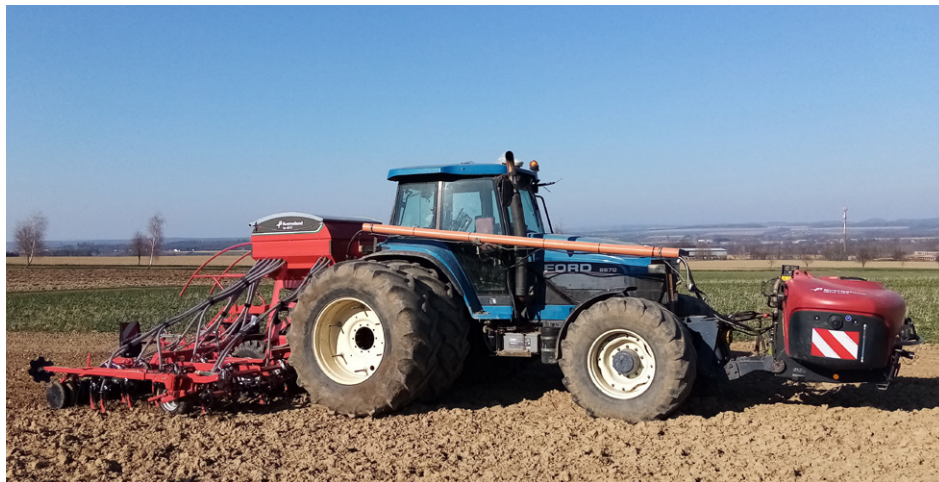
Obr. 22: Modifikace secího stroje Kverneland ts-drill (záběr 6 m) pro výsev plodin do řádků 0,25 m se souběžnou aplikací bakterií do výsevni rýhy z čelně nesené nádrže Kverneland iXtra (foto Brant).
