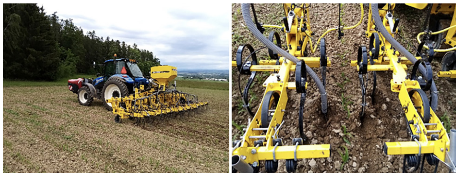
Obr. 69: V systémech pomocných plodin lze pro regulaci pomocných plodin v meziřádku využít mechanickou kultivaci, či aplikaci herbicidu do meziřádku (foto Brant).
