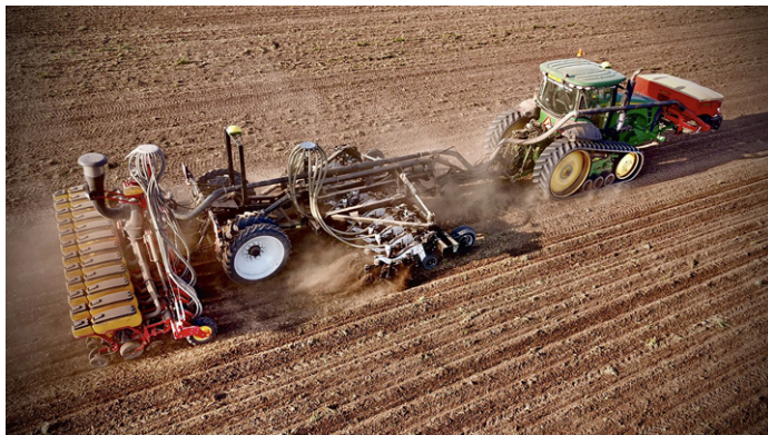
Obr. 74: Výsev sóji soupravou složenou ze secího stroje Väderstad Tempo, čelního zásobníku hnojiva FH2200 a strip-till strojem SLY StripCat II. S prutovými agregáty pro mělké kypření s roztečí výsevních sekcí 0,5 m (foto Švarc).
