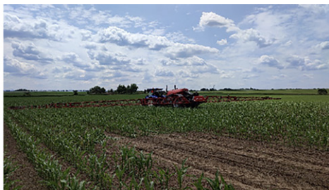
Obr. 68: Pro pásovou aplikaci přípravků na ochranu rostlin v sóje lze využít konvenční postřikovače se základní roztečí trysek 0,25 m a s možností individuálního vypínání jednotlivých trysek. Tyto technické prostředky jsou do stupně jako samohodné, ale i tažené a nesené (foto Brant).
