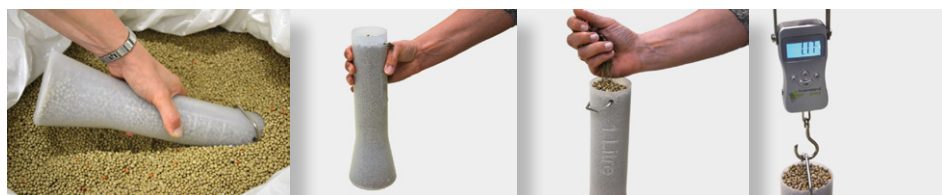
Obr. 46: Stanovení objemové hmotnosti konkrétního hnojiva (foto Kverneland Group).
