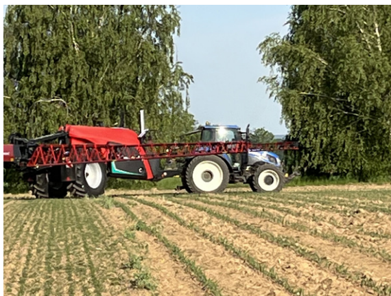
Obr. 48 : Omezení zhutnění půdy a poškození porostů na souvrati při výjezdu a nájezdu do ozeleněných trajektorií lze eliminovat systémy vedení taženého postřikovače přímo ve stopě traktoru (foto Dvořák).
