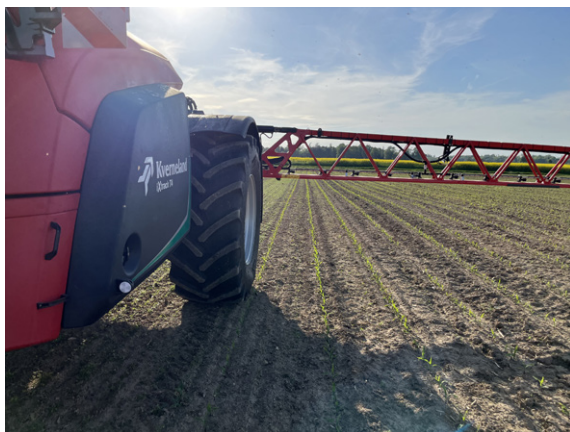
Obr. 47 : Tažený postřikovač iXtrack T4 4000 I se záběrem ramen 36 m HSS a cirkulací iXflow-E® s individuálním ovládním trysek osazený pneumatikami s rozměry 710 / 70 R 38 (foto Dvořák).
