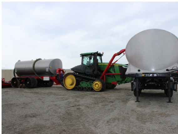
Obr. 49 : Aplikátor kapalných organických hnojiv a látok osazený pásovým podvozkom v kombinácii s doplňovaním nádrže (foto Kroulík).
