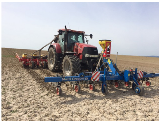
Obr. 57: Založení porostu kukuřice se současným osemem kolejových řádků (foto Kroulík).
