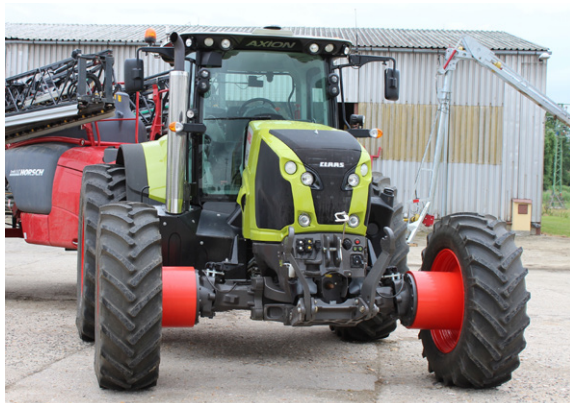
Obr. 51: Úprava rozchodu kol nebo pásů na shodné rozměry vede k celkovému snížení čet- nosti přejezdů (foto Kroulík).
