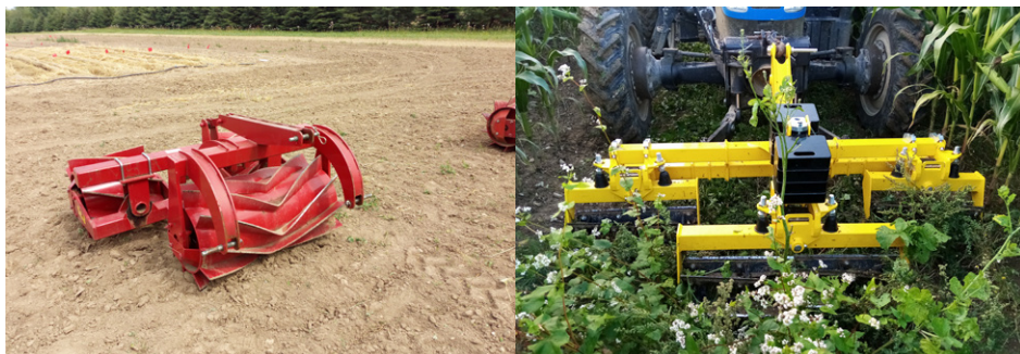
Obr. 11 : Pro technologii ozeleněných trajektorií je vhodnější použít řezné válce se možností změny záběru, které lze dobře přizpůsobit požadovaným podmínkám zemědělského subjektu (foto Brant).
