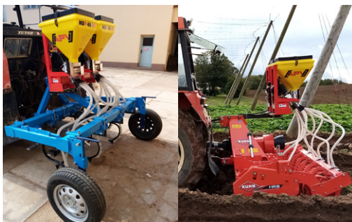
Obr. 6 : Modifikace strojů pro zpracování půdy pro souběžný výsev plodin (foto Brant).
