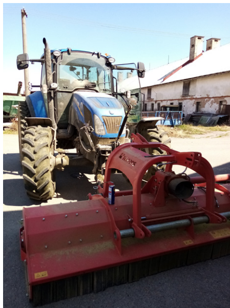
Obr. 8 : Čelně nesený mulčovač s pracovním záběrem 3 m používaný pro regulaci porostů na ozeleněných řádkách v subjektu Statek Bureš, s.r.o. (foto Brant).
