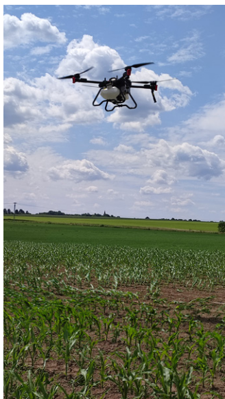
Obr. 52: Aplikací bezpilotní prostředek vybavený nádrží na kapalinu. Nádrž je možné zaměnit za zásobník na granulát nebo osivo (foto Kroulík).
