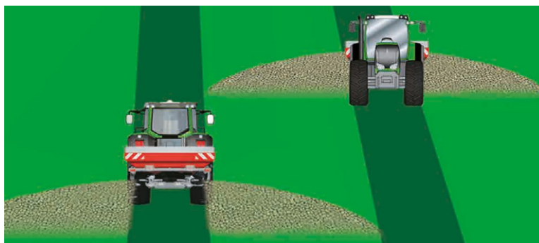
Obr. 44 : Středový deflektor umožňuje odklonění aplikovaného hnojiva mimo plochu řádku, čímž je hnojivo aplikováno pouze po bocích nehojeného řádku (foto Kverneland Group).
