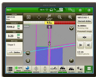
Obr. 61: Vnitřní hranice přebírá také terminál traktoru a ovládá sekce sečích strojů, pleček nebo postřikovačů (foto Osorno s.r.o.).
