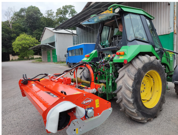
Obr. 7 : Mulčovače s horizontální osou rotace a s možností bočního ukládání mulče do míst kolejových stop aplikátorů (foto Brant).
