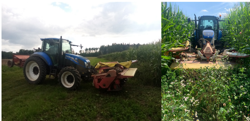
Obr. 9 : Z hlediska omezení povalení porostu před mulčováním a sečením koly tažného prostředku, i ve vztahu k jednodušší práci obsluhy pracovní soupravy, je primárně vhodné volit čelně nesené žací stroje (foto Brant).
