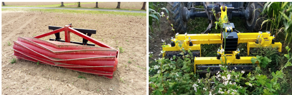
Obr. 96: Rozdílné systémy konstrukce řezných válců, které lze použít pro regulaci brukvovitých meziplodin (foto Brant).
