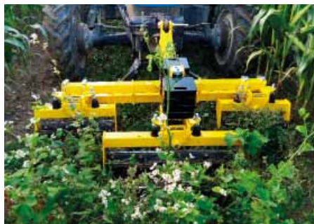
Obr. 44: Těžké řezné válce dobře regulují i porosty obilnin vytvářející pevnější stébla. Plná stěna válců částečně omezuje tzv. namotávání biomasy. Válce lze rozdělit na dělené s možností kopírování (vlevo), či na pevné (vpravo) bez možnosti změny pracovního záběru (foto Brant).
