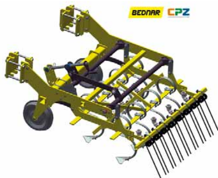
Obr. 49: Konstrukční nákres (vlevo, BEDNAR FMT) a realizace vnitřní kypřicí sekce (vpravo, foto Brant) zajišťující možnost kombinace zonálního kypření s celoplošnou kultivací plochy meziřadí.
