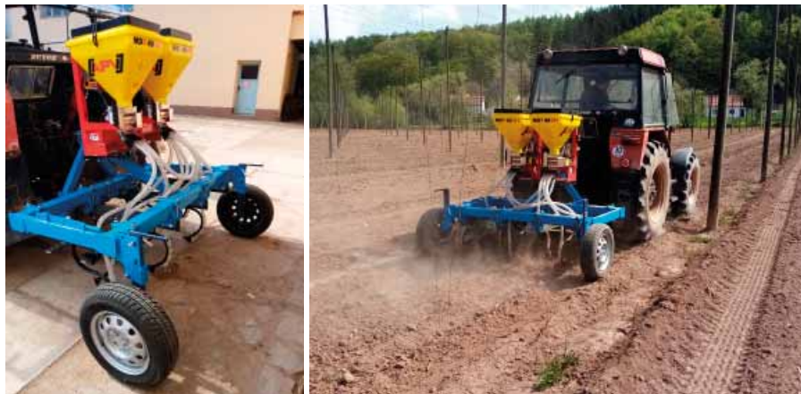
Obr. 47: Obrázky dokumentují vyvinutý kypřič pro výsev a zachycuje jeho práci ve chmelnici (foto Brant).
