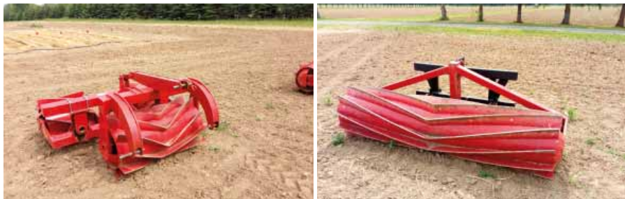
Obr. 44: Těžké řezné válce dobře regulují i porosty obilnin vytvářející pevnější stébla. Plná stěna válců částečně omezuje tzv. namotávání biomasy. Válce lze rozdělit na dělené s možností kopírování (vlevo), či na pevné (vpravo) bez možnosti změny pracovního záběru (foto Brant).
