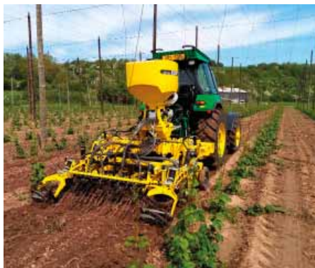
Obr. 50: Konstrukční nákres (vlevo, BEDNAR FMT) a realizace stroje při osazení kypřicí sekcí (vpravo, foto Brant).
