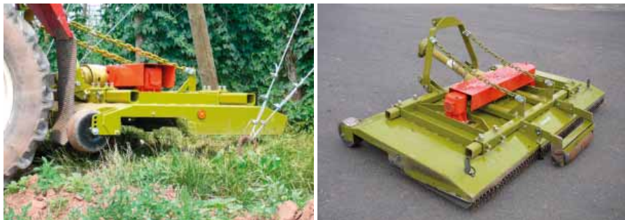
Obr. 42: Mulčovače s vertikální osou rotace lze efektivně použít i pro cílený odhoz biomasy (foto Ježek).
