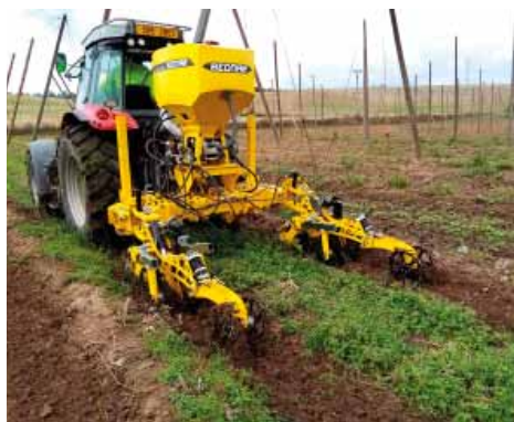
Obr. 48: Kypřič pro cílené zonální kypření a hnojení ke kořenové zóně (foto Brant).
