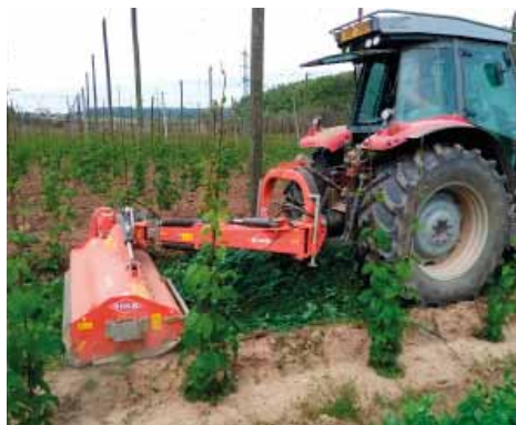
Obr. 41: Mulčovače s horizontální osou rotace efektivně pracují i na plochách s vysokou produkcí nadzemní biomasy (foto Brant).
