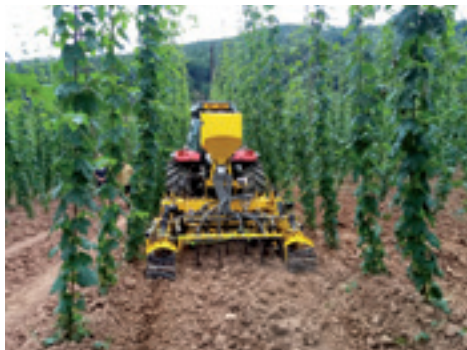
Obr. 34: Kypřicí radlice zvedá půdu do prostoru mezi usměrňovací disky, které ji vracejí do kypřeného pásu – ověřovaná konstrukční řešení (foto Brant).
