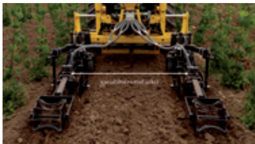
Obr. 36: Rám stroje umožňuje změnu rozteče kypřících sekcí i přidání dalších pracovních nástrojů mezi sekce, například pro mělké kypření meziřadí (foto Brant).
