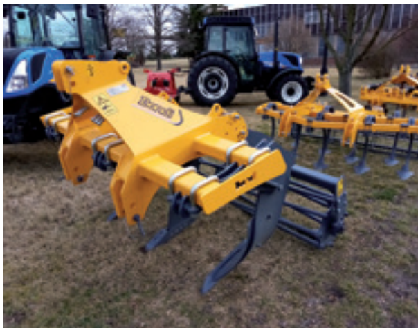
Obr. 26: Kolmé rovné slupice zakončené dlátem za optimálních půdních podmínek dobře rozrušují spodní vrstvy půdy (nahore), dole je dlátový kypřič s bočně parabolicky zahnutou slupicí (foto Brant).
