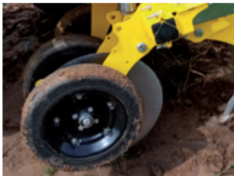
Obr. 35: Řezný disk s opěrnými koly nařezává půdu v budoucí trajektorii kypřicí radlice za účelem kvalitního kypření – ověřovaná konstrukční řešení (foto Brant).
