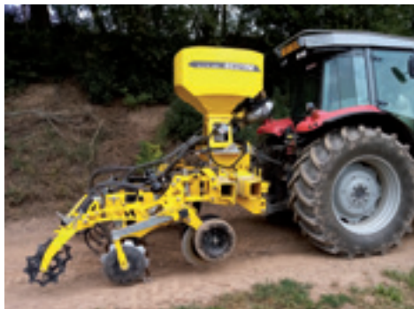
Obr. 34: Kypřicí radlice zvedá půdu do prostoru mezi usměrňovací disky, které ji vracejí do kypřeného pásu – ověřovaná konstrukční řešení (foto Brant).
