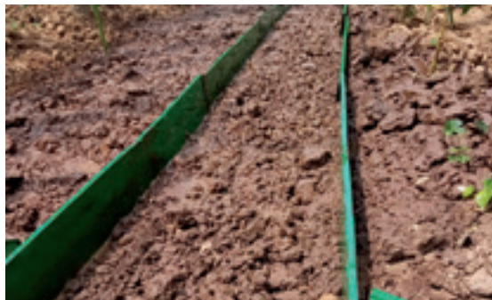
Obr. 74: Nakypřené kolejové stopy během simulace deště. Z obrázku je patrné, že díky rozrušení utužené vrstvy dokáže srážková voda lépe infiltrovat do půdy (foto Kabelka).
