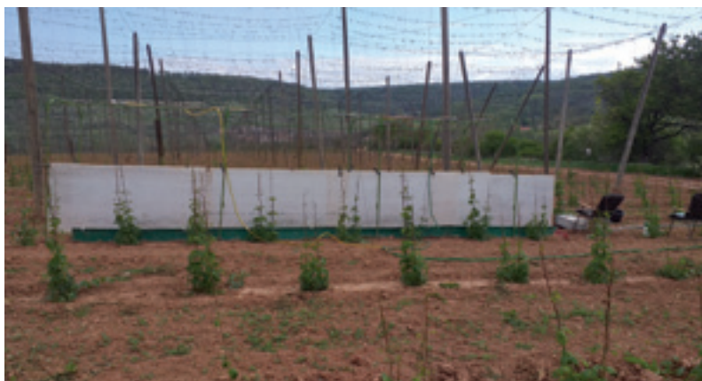
Obr. 60: Polní simulátor deště využívaný na VÚMOP umístěný ve chmelnici (foto Kabelka).
