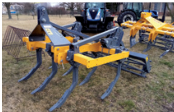
Obr. 28: Pro kypření odpovídající spíše podrývání až dlátování lze využít i stroje s více řadami pracovních nástrojů (foto Brant).
