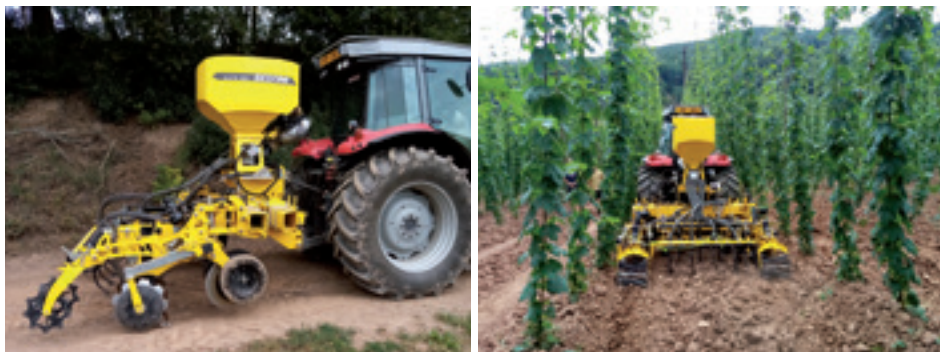
Obr. 29: Prototyp stroje navržený pracovníky ČZU a zkonstruovaný ve spolupráci s firmou BEDNAR FMT při testování (foto Brant).
