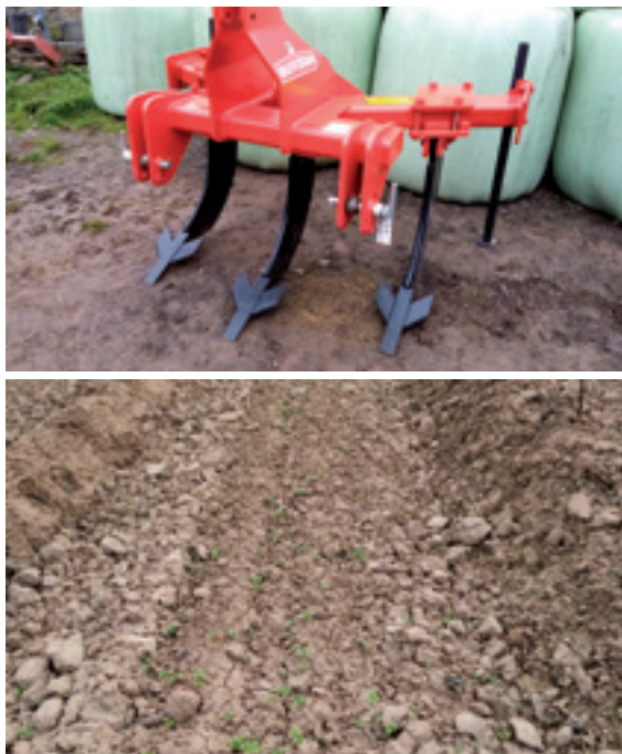
Obr. 27: Setkat se lze i s konstrukcemi pracovních nástrojů osazených ve spodní části postranními křídly (nahore). Za optimálních půdních podmínek zajišťují tyto konstrukce i velmi dobré nakypření povrchu půdy a poté obrázek dole, (foto Brant).
